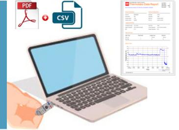
Branchez Sensolabo® SUB ECO sur le port USB d'un ordinateur. Les Fichiers PDF et CSV sont Automatiquement Générés et mis à disposition de votre destinataire.
